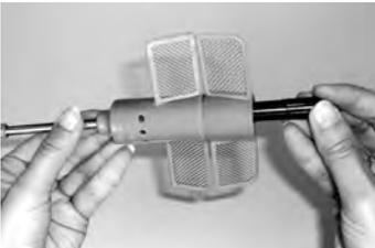
Drücken Sie die beiden Flügel mit Kraft fest auf die Welle, bis die Flügel eingerastet sind und nicht mehr von der Welle rutschen können.
