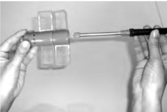
Stecken Sie die Antriebswelle durch die beiden Flügel.
